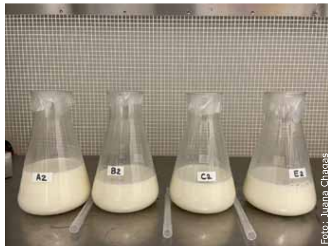
Figur 2. Labtest där mjölken manipulerats genom tillsats av olika estrar.
