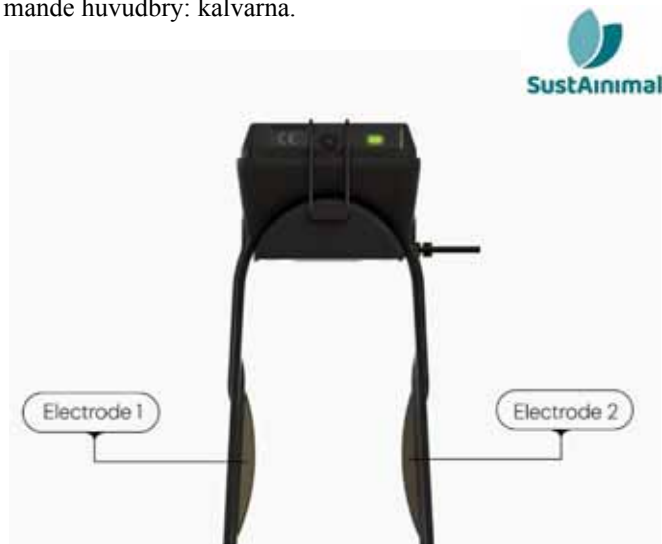
Figur 3. Elektrodernas placering på halsband från Monil. Källa: Monil.
